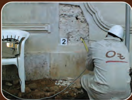
Observação boroscópica de uma parede
