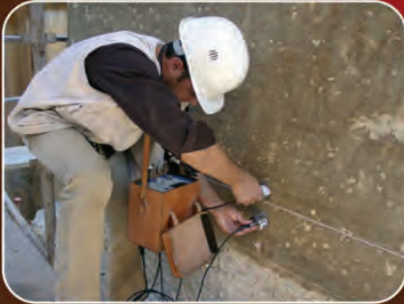
Ensaio de ultra-sons na Ponte Angeja
