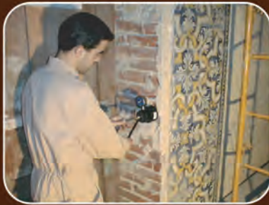
Avaliação das propriedades mecânicas de uma argamassa de assentamento, através do ensaio de arrancamento de uma hélice
