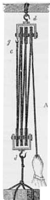
c) Estralheiras: o esforço é dividido pelo número de cordões (6, na figura)
