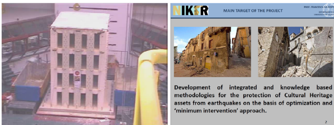
Figura 2. Projetos Comrehab e Niker - Desenvolvimento de técnicas de reabilitação sísmica de construções antigas (Fotos Stap e Niker).
