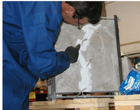
Prova prática de qualificação de um operador de equipamento de injeção de polímeros.
